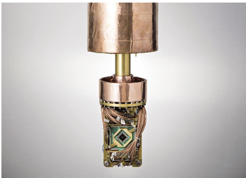
Die Prozessoreinheit des Quantencomputers 2000Q von D-Wave muss auf -273 Grad Celsius heruntergekühlt werden. Foto: D-Wave
